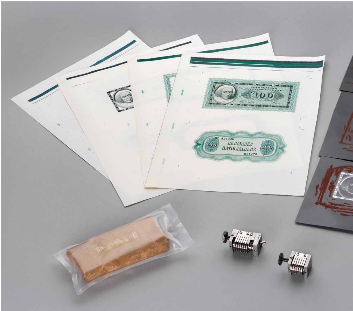
Fig.6 Eksempler på udstyr fra kasserne: fire skalatryk, tre fotografiske negativer, fem plomberede numme- ratører og to (i 2010) udpakkede nummeratører. Den mindste numme- ratør er den manuelle på ca. 2 x 2 x 4 cm.
