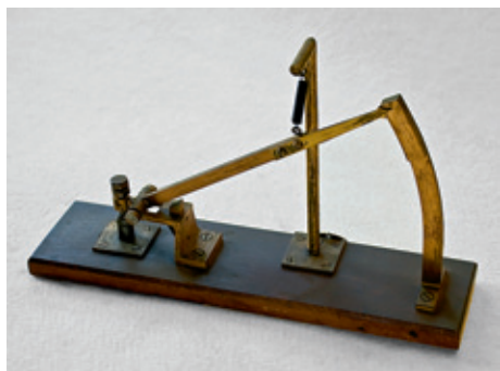
Fig. 13. Instrument til at måle en tens tykkelse med. Tenen placeres i venstre side, hvorved udsvinget (tykkelsen) kan aflæses på skalaen til højre. Fra Montén i København, formentlig slutningen af 1800-tallet. Danmarks Tekniske Museum.
