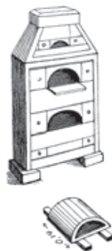
Fig. 8. Muffel og muffelovn. En muffel var en ildfast beholder med buet låg, der var åben i enderne. Den sørgede for, at de genstande, der skulle opvarmes ikke kom i direkte kontakt med flammerne. Illustration fra E. Schlösser: Die Münztechnik , Hannover 1884.
