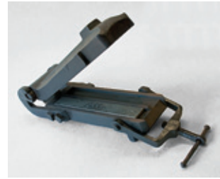
Fig. 9. Jernform til støbning af to tene. Én ten er placeret deri. Fra Mønten i København før 1889. Danmarks Tekniske Museum.
